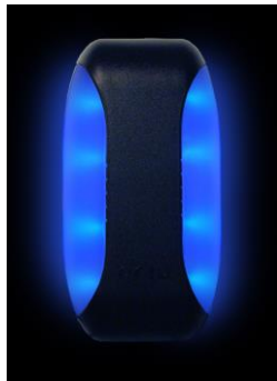
Oczekiwanie na zbliżenie identyfikatora w trybie monostabilnym
