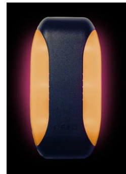
Odczyt identyfikatora zawieszonego lub poza dozwolonym czasem na użycie
